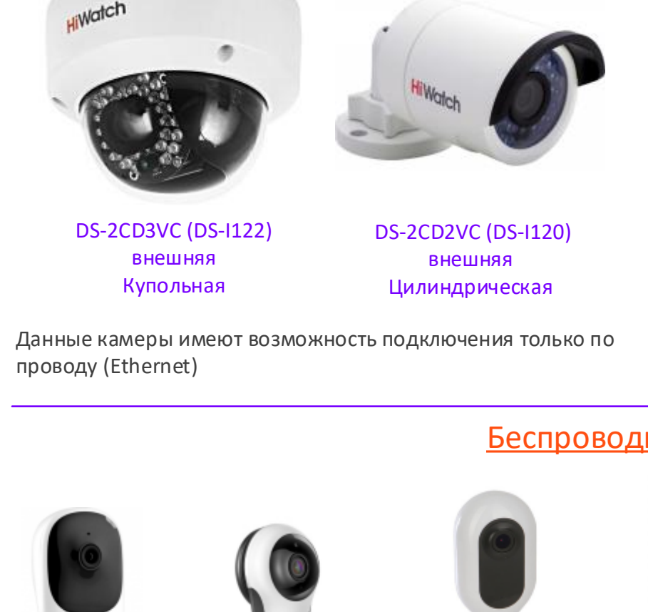
Данные камеры имеют возможность подключения только по проводу (Ethernet)
